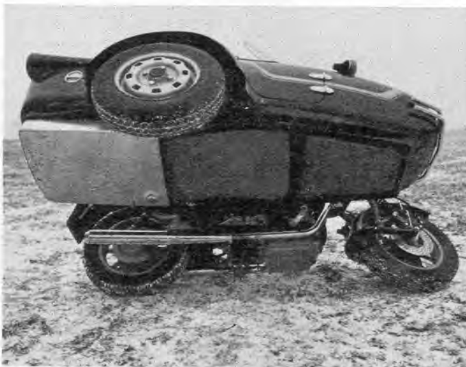
Der 30 Liter-Leichtmetalltank unter dem Bootscheck
